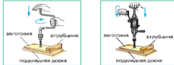
3. Выполните пиление, строгание, сверление брусков из древесины:
