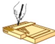
5. С помощью линейки отложите на обеих вертикальных линиях ширину Б детали.
